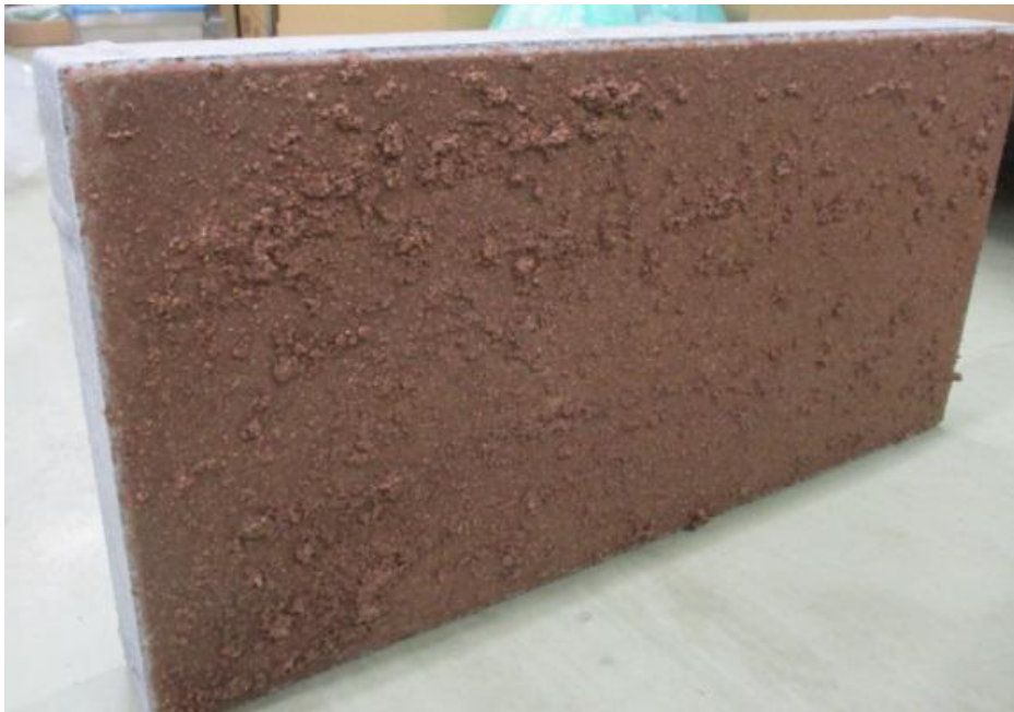
コンクリートに塗付した状態
